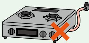
不使用のネジガス栓には必ずプラグを取り付けます。
